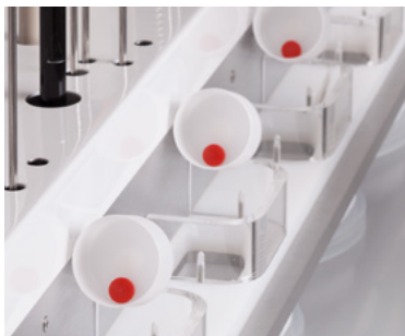
Simultaner Tabletteneinwurf ermöglicht hohe Genauigkeit der Abläufe.
