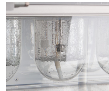
Automatische Reinigung nach jedem Testdurchlauf mit Reinigungsprüfung (SST).
