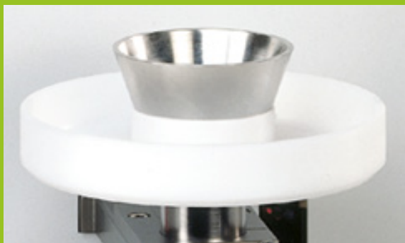
Optionaler Überlaufschutz für Methoden mit 100 mm und 200 mm Zylinder.
